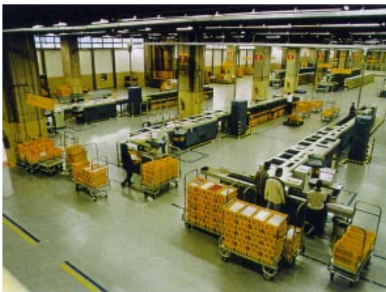
Máquina de triagem dos Correios para correspondências e ações de Marketing Direto.
